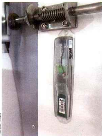
UNE SONDE POSITIONNÉE DANS LA REMORQUE PERMET DE SUIVRE LA TEMPÉRATURE.
